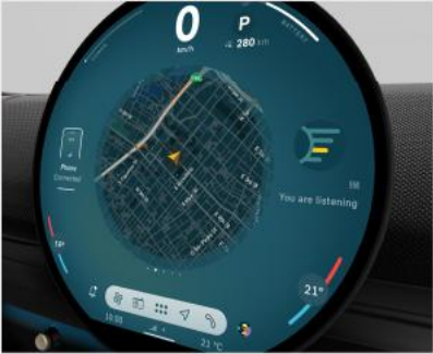
Pantalla central OLED de 240 mm de diámetro.
